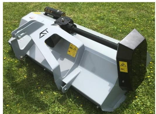
**SAFETY FIRST!** Große Gehäuseübergänge am STS 25, sowie Gummischürzen vorne und hinten verhindern das Austreten von Steinen und sonstigen Gegenständen. Das Mulchen wird so zur sicheren Arbeit.
